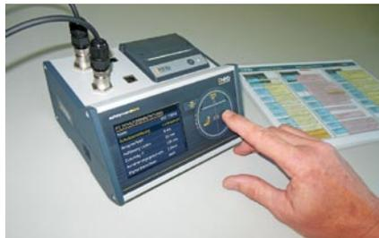
Zur richtigen Berechnung des Sicherheitsabstandes werden Typ und Spezifikationen der Schutzeinrichtung vom Messgerät in einem leicht zu bedienenden Menü abgefragt.
