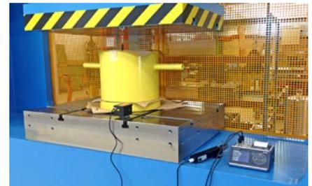
Der Wegsensor ist einfach mit Haftmagneten an der Maschine anzubringen. Er erfasst die Maschinenbewegung. Für Drehbewegungen stehen Reibrad-Encoder zur Verfügung.
