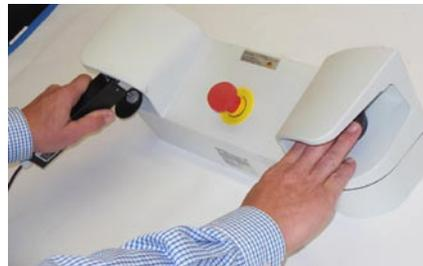
Zur Messung wird die Maschine angefahren bis sie die höchste Geschwindigkeit erreicht hat. In dieser Position wird die Schutzeinrichtung aktiviert, ein Maschinenstopp wird eingeleitet und die Messung der Nachlaufzeit beginnt.
