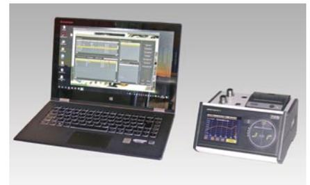
Nachlaufzeit, Nachlaufweg und der errechnete Sicherheitsabstand werden direkt nach jeder Einzelmessung angezeigt. Ein Messprotokoll mit allen Angaben wird erstellt und automatisch im Messgerät gespeichert. Zeitunabhängig können die Daten von einem PC ausgelesen werden.
