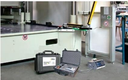
Der Safetyman DT2 ist bestens geeignet für den mobilen Einsatz. Das Messgerät mit dem kompletten Zubehör befindet sich in einem stabilen Koffer mit speziellem Interieur.
