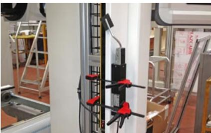
Der Aktuator wird zum Auslösen der Schutzeinrichtung vorbereitet - ganz ohne elektrischen Anschluss an die Maschine. Ob Lichtvorhang, Scanner, Zweihandschaltung oder andere Schutzeinrichtungen, der Aktuator Auto-Hand ist geeignet diese auszulösen.
